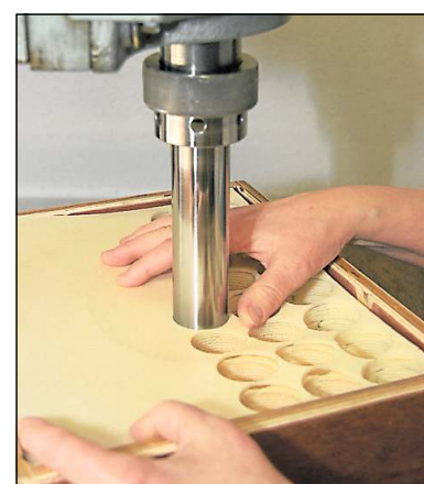
Moderne Technik: Beim Ausstechen frisst sich ein Bohrer durch 50 Teigplatten gleichzeitig hindurch.
