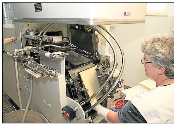
Sieht aus wie Waffeleisen am Fließband: Diese Maschine verwandelt den flüssigen Teig in feste Quadrate.
